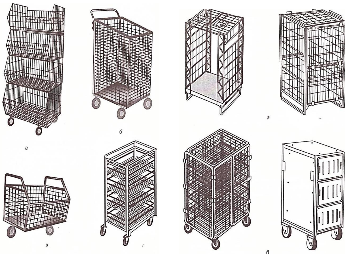
Рис. 4. Тара-обладнання: а — гірка пересувна секційна універсальна; б, в — контейнери для викладення плодовоовочевої продукції; г — гірка для молочних продуктів
